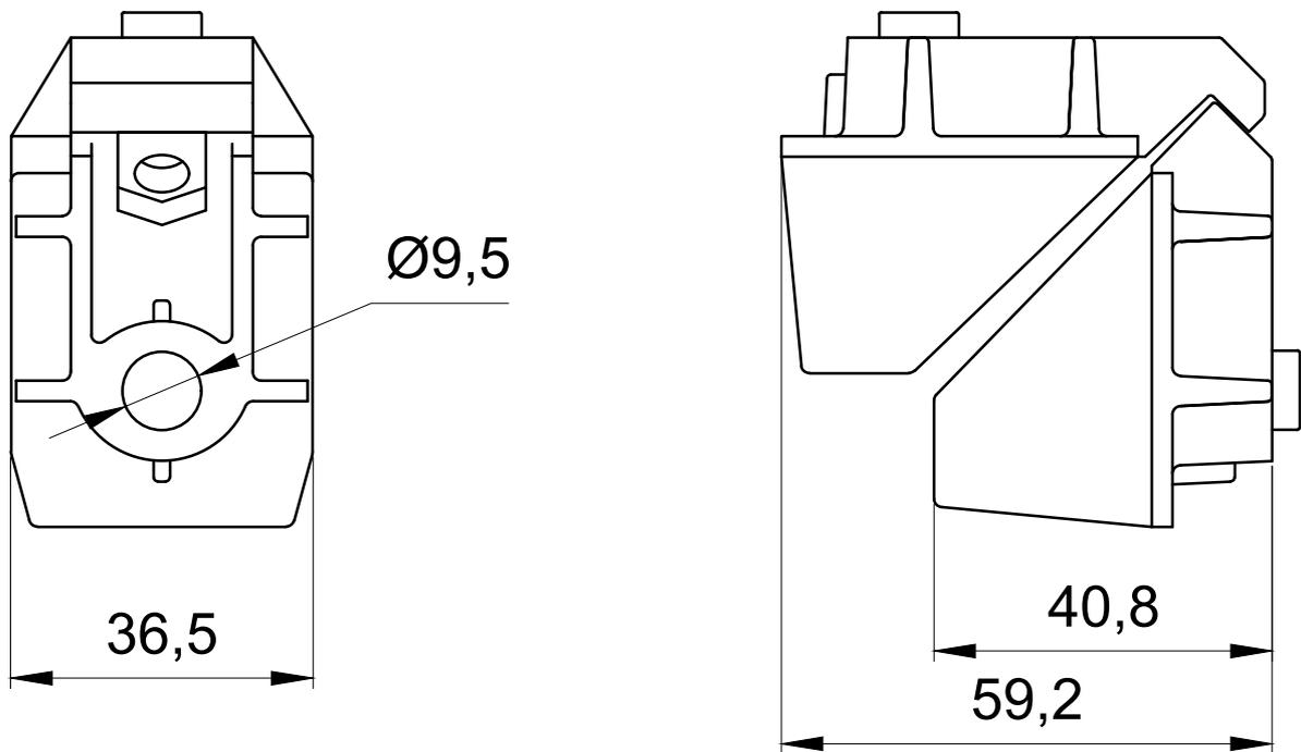
Кнопочная закладная СТН-2187 аналог MONTICELLI 0330
